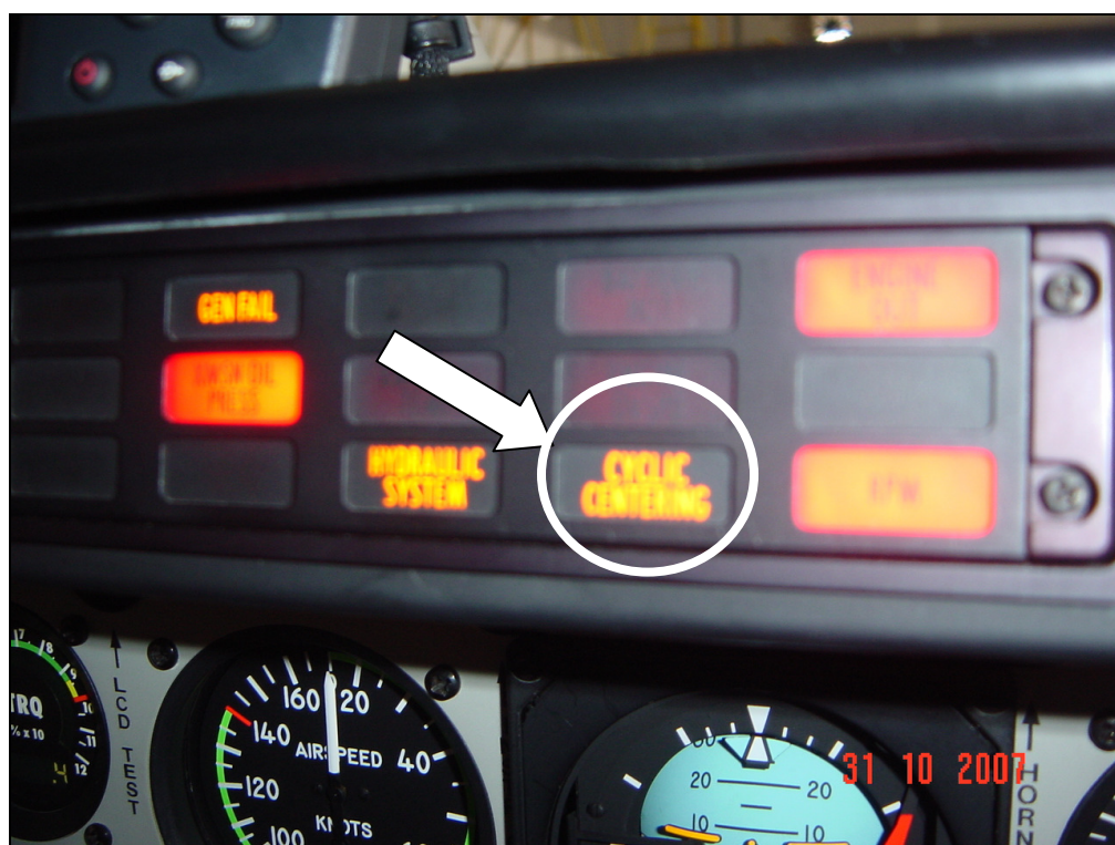
Figura 10 – Detalhe da luz de alerta Cyclic Centering
