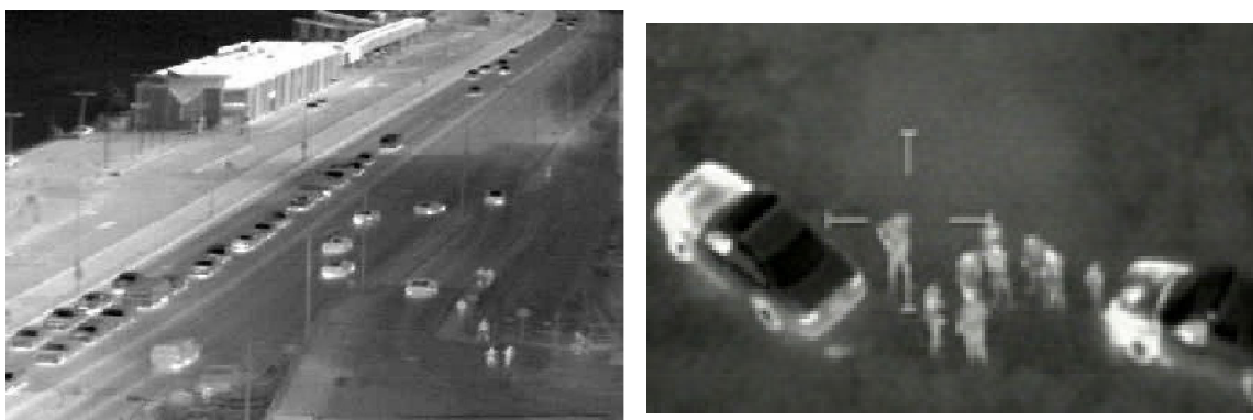
Figura 18 - Viaturas e Policiais Vistos Através do FLIR. Nota-se que os veículos foram usados recentemente pela imagem do aquecimento causado aos capôs e sistemas de freios. Fonte: Flir, Inc.
