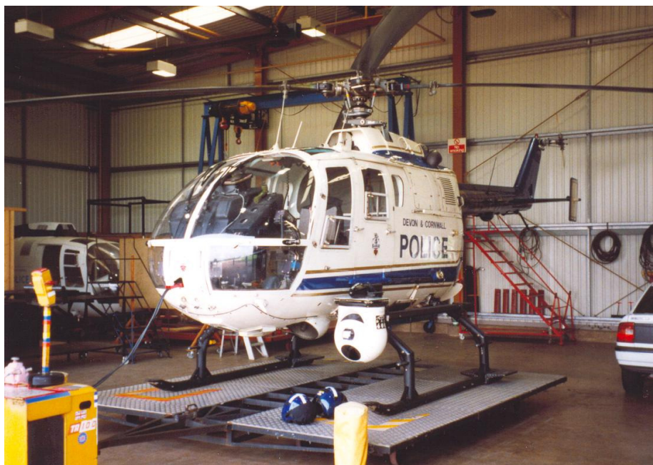
Figura 20 - Bölkow BO 105 da Polícia do Condado de Devon & Cornwall. O helicóptero é mantido em prontidão dentro do hangar, sobre esteira móvel, pronto para ser trazido para fora enquanto a tripulação coloca os cintos. Note-se inclusive a fonte externa já ligada ao nariz da aeronave. Fonte: Autor.
