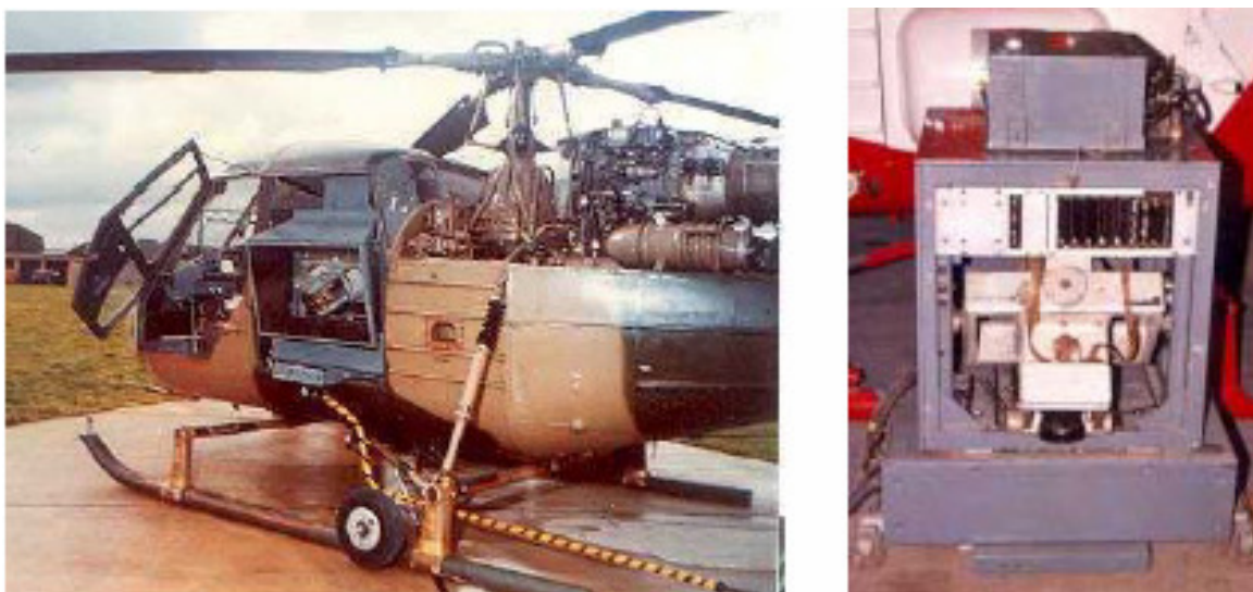
Figura 19 - Equipamento Original de Downlink Marconi, Preservado no Museu do Helicóptero do Reino Unido. Fonte: UK Helicopter Museum.
