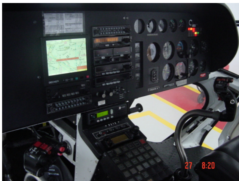
Figura 17 - Vista Interna da Cabine do Helicóptero da PMESP. Nesta foto pode-se observar o equipamento de navegação ligado. Fonte: Falconi, Carlos Eduardo
