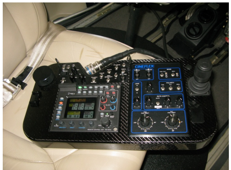
Módulo de controle através do qual o operador realiza os movimentos da câmera e ajustes como tipo de imagem, filtros de luz, zoom, foco e outros tantos que são possíveis de serem realizados.
