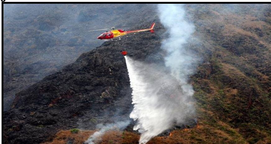
Figura 36 - Combate a Incêndio Florestal utilizando o Bambi Bucket
