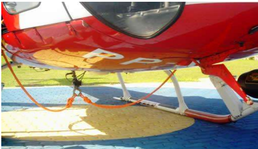
Figura 20- Ancoragem e ponto bomba no cargo hoist .
