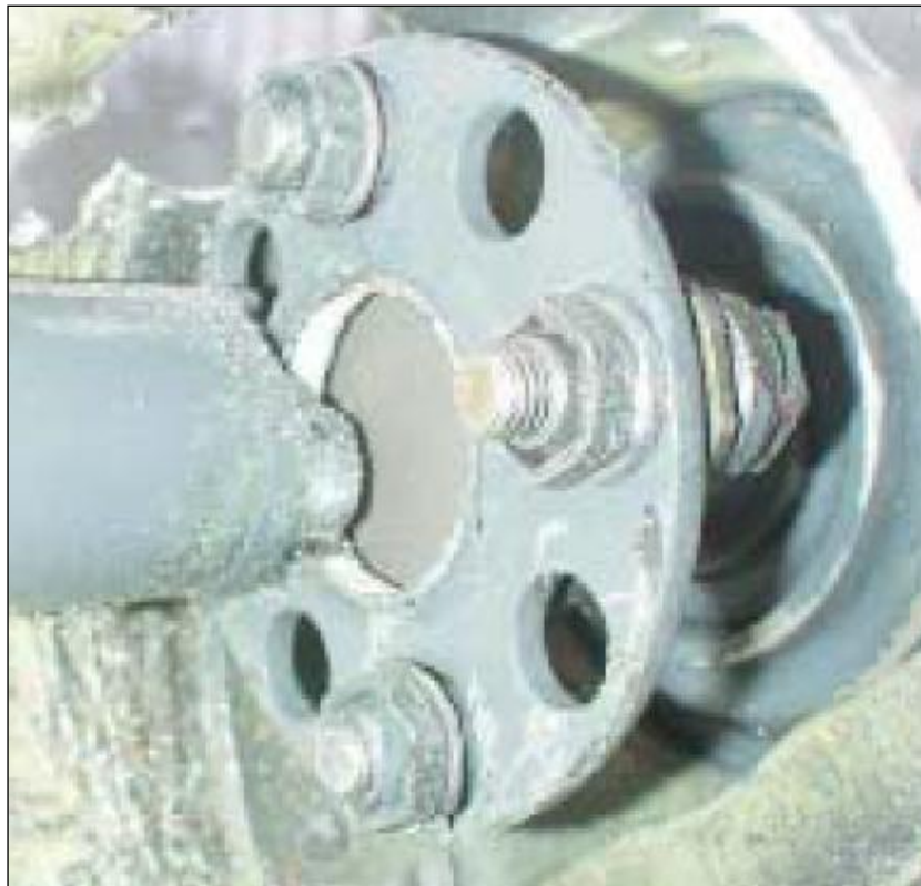
Figura 9 - Região de rompimento do eixo do rotor durante o voo do helicóptero Robinson R22, prefixo ZK-HVN, acidentado em 2005.
