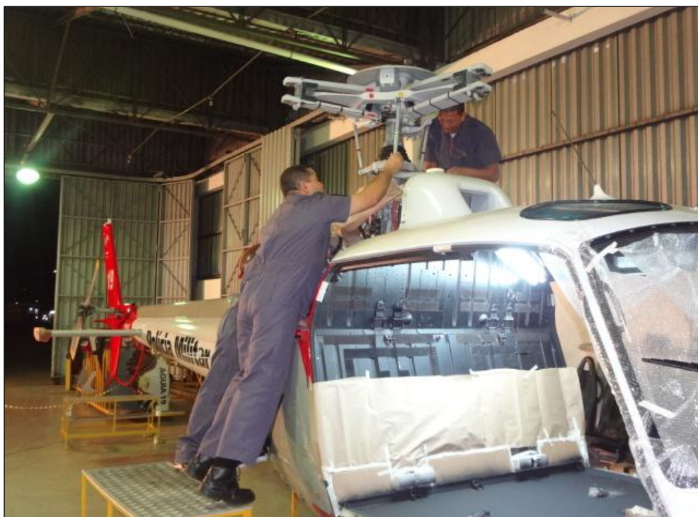
Figura 41 - Experiência da inspeção progressiva noturna. Fonte: Imagem obtida pelo próprio autor no hangar do GRPAe.
