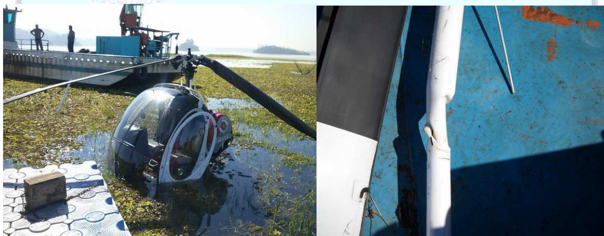
Figuras 4 e 5 – Característica de danos das pás do rotor principal e do eixo rotor de cauda.
