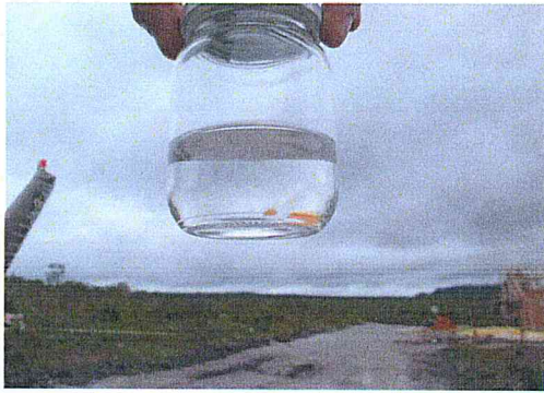
Foto 1 – aspecto do combustível retirado da aeronave no local do acidente
