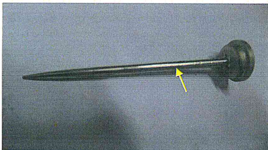
Foto 7 – agulha da metering valve da FCU
