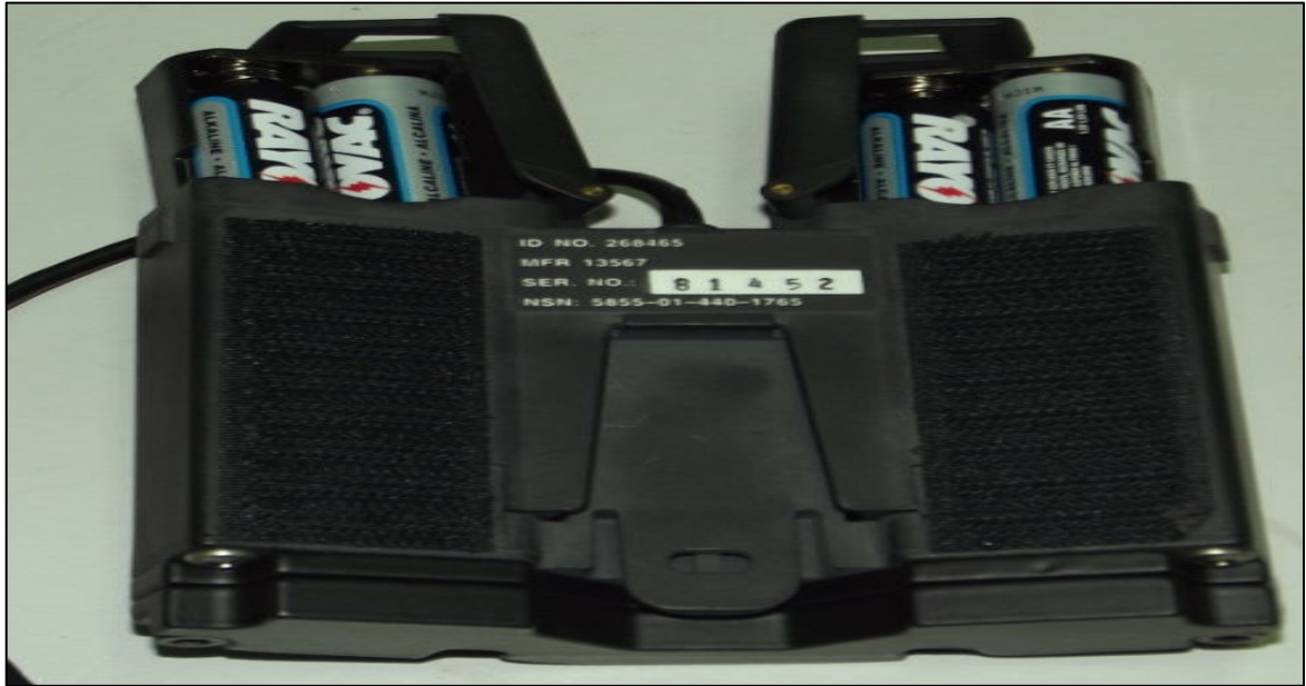
Figura 9 - Conjunto de potência ou fonte de energia com dois conjuntos de baterias
