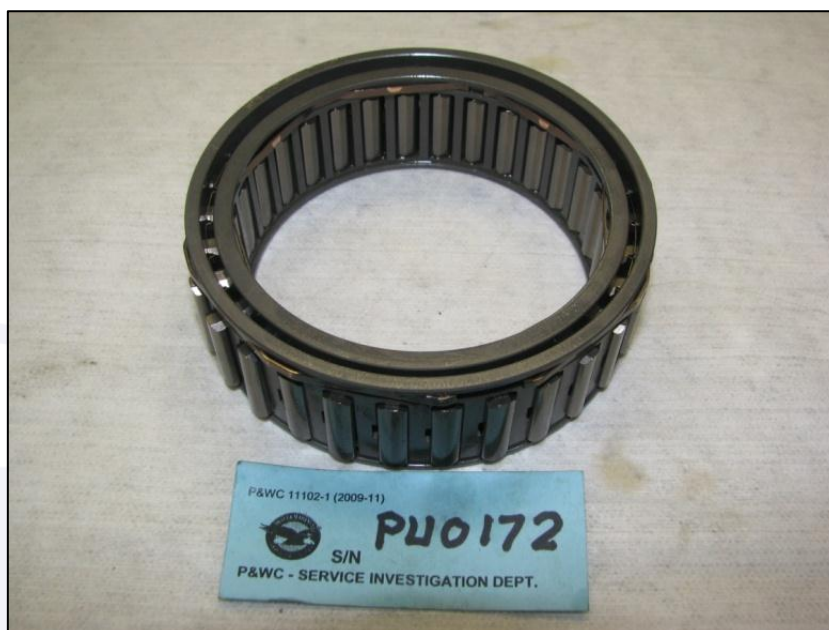
Figura 77 - Vista geral do rolamento da roda livre.
