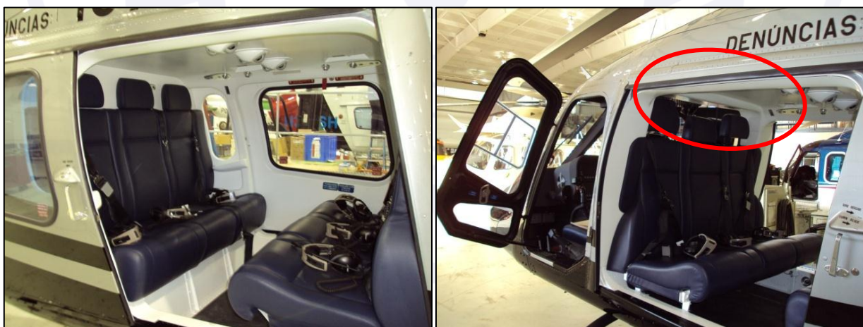
Figuras 1 e 2 - Configuração interna do PP-CGO. Em destaque, a abertura entre as cabines dos passageiros e dos pilotos.
