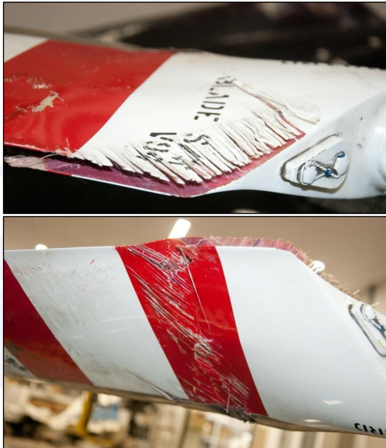
Figuras 31 e 32 - Detalhes da pá do rotor de cauda. As fraturas e delaminações ocorreram por impacto contra o solo.
