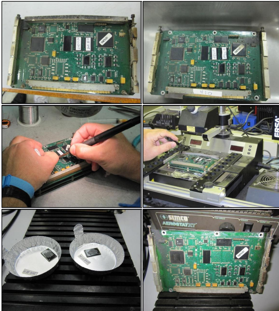
Figuras 62, 63, 64, 65, 66 e 67 – Sequência de fotos mostrando a retirada da memória não volátil das EDUs instaladas no PP-CGO e sua posterior instalação na placa de testes da Astronautics Corporation.
