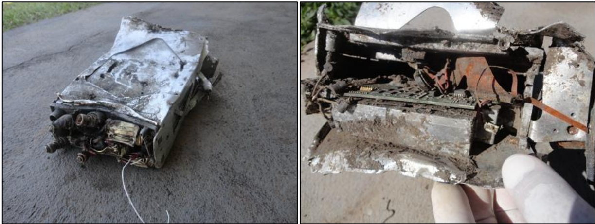
Figura 15 e 16 – GPS modelo Garmin GNS430W retirado dos destroços do PP-CGO.
