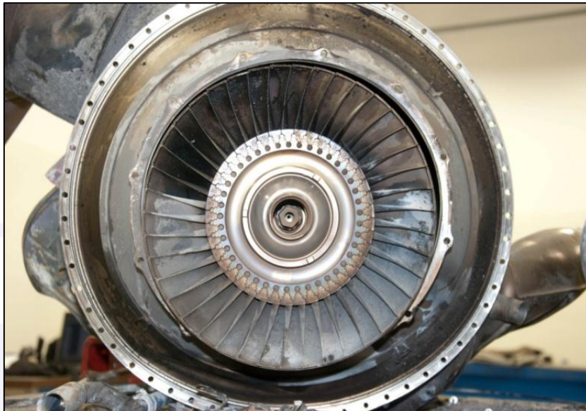
Figura 55 – Vista anterior do rotor da turbina de potência.
