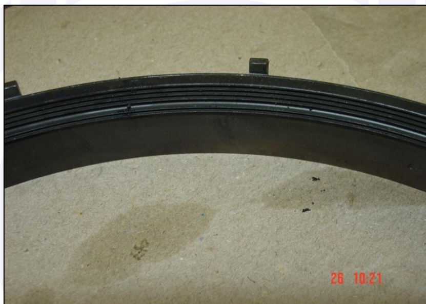
Figura 58 – Detalhe das canaletas em outro ponto do anel de vedação.
