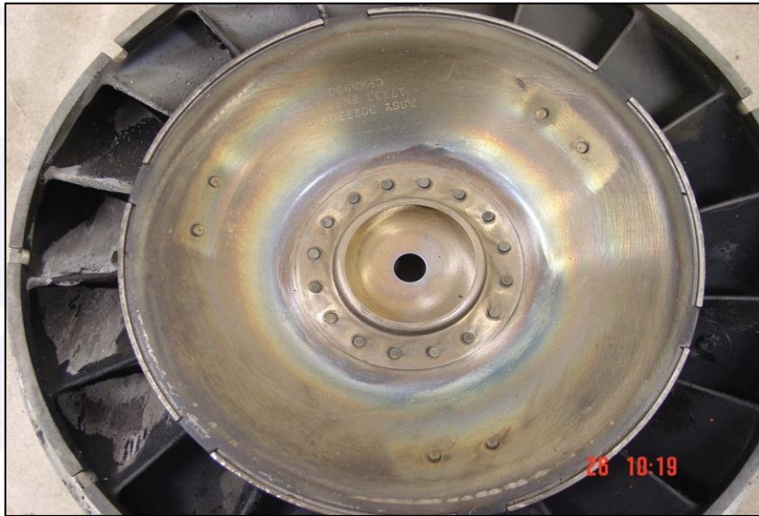
Figura 53 - Diafragma com marcas de roçamento leve deixadas pelas raízes das palhetas do rotor da turbina do compressor.
