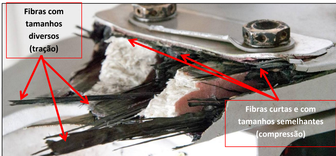
Figuras 22 - Detalhe da fratura vista pela parte superior. Pode-se observar na superfície da fratura regiões de compressão e de tração.
