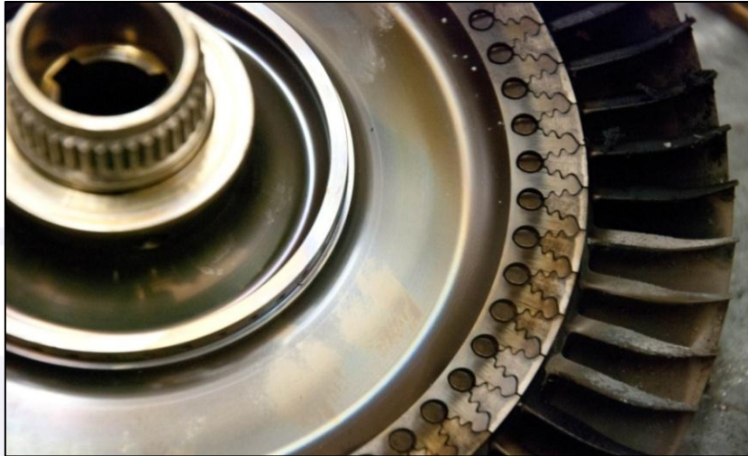
Figura 50 – Marcas de roçamento leve na raiz das palhetas.
