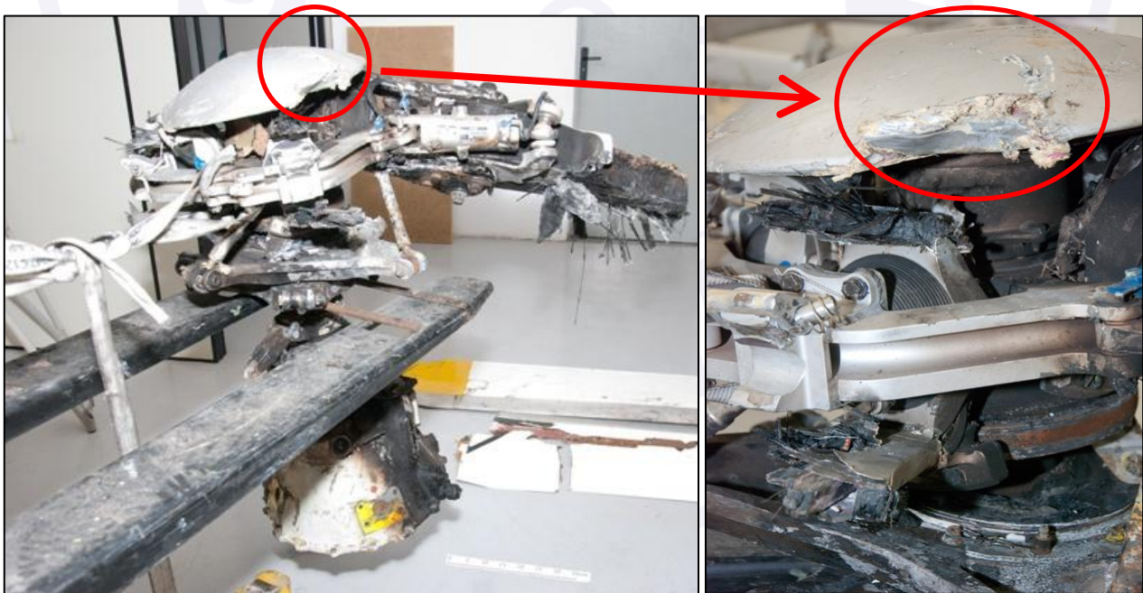
Figuras 33 e 34 – À esquerda, a transmissão principal. À direita, detalhe do “chapéu chinês” com entalhe produzido, provavelmente, pelo movimento vertical da pá azul.
