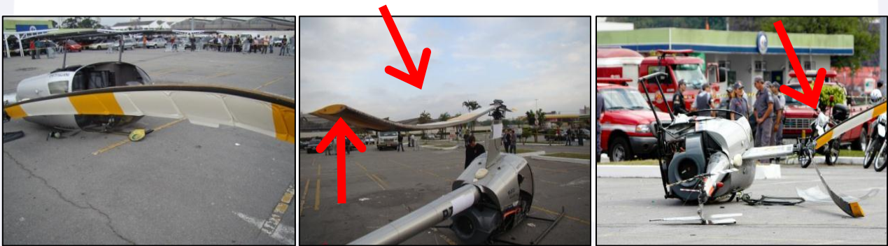
Figuras 89, 90 e 91 - Situação das pás do rotor principal do PT-YZZ após o acidente. Em destaque, detalhes do enflechamento das pás para cima.
