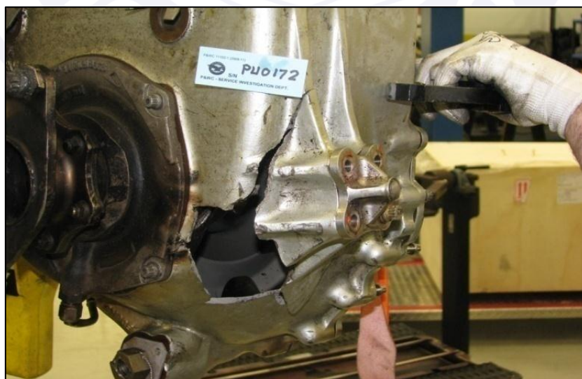
Figura 73 - Fratura decorrente do impacto sofrido pela RGB no acidente.
