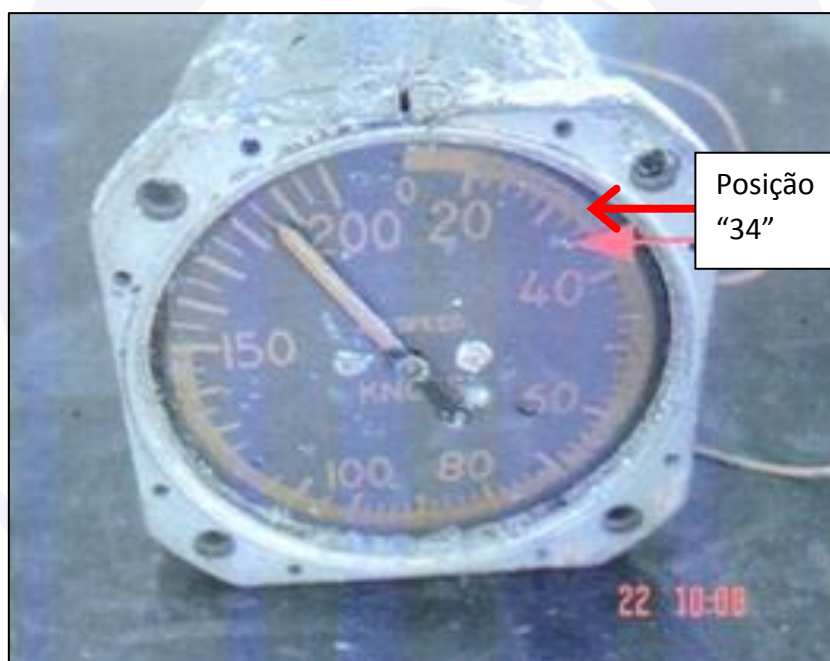
Figura 60 – Velocímetro sob ação de luz branca. Em destaque, o único ponto que poderia ter sido causado pelo ponteiro (posição “34”), mas que não foi considerado como evidência pelo Relatório 20-E/2012.
