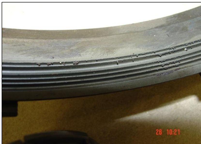
Figura 57 – Detalhe das canaletas de vedação do anel.
