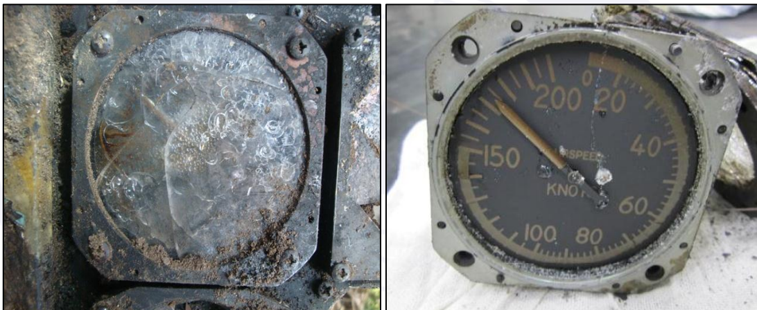
Figuras 10 e 11 – Velocímetro indicando 174 nós. A figura da direita apresenta o mesmo instrumento, após a remoção da proteção de vidro danificada pelo impacto.
