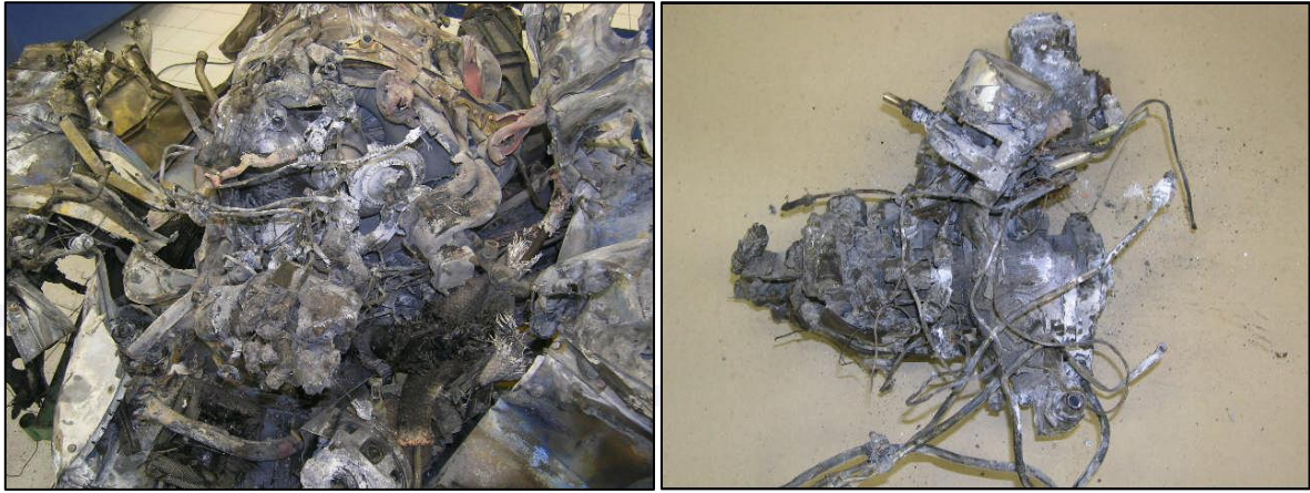
Figuras 46 e 47 – À esquerda, a caixa de acessórios do motor. À direita, a bomba de combustível ( High Pressure Fuel Pump ) e a FCU ( Fuel Control Unit ).
