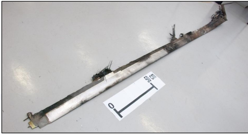
Figura 28 - Pá do rotor principal.
