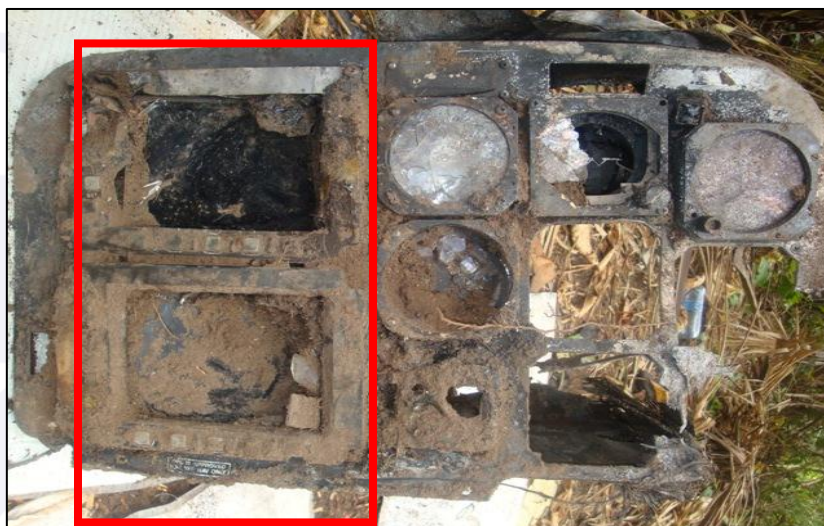
Figura 61 – Painel retirado dos destroços do PP-CGO. Em destaque, as duas EDUs levadas para análise nos EUA.
