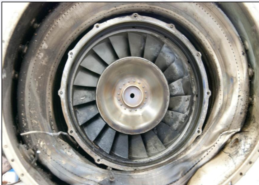
Figura 54 – Vista posterior do estator da turbina de potência com o diafragma.
