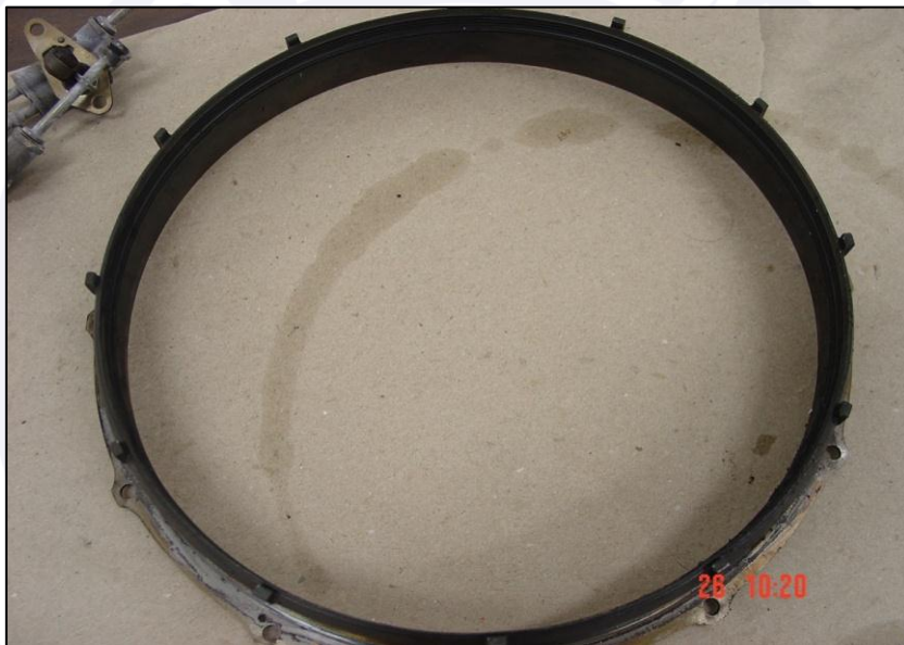
Figura 56 – Vista geral do anel de vedação do rotor da turbina de potência.
