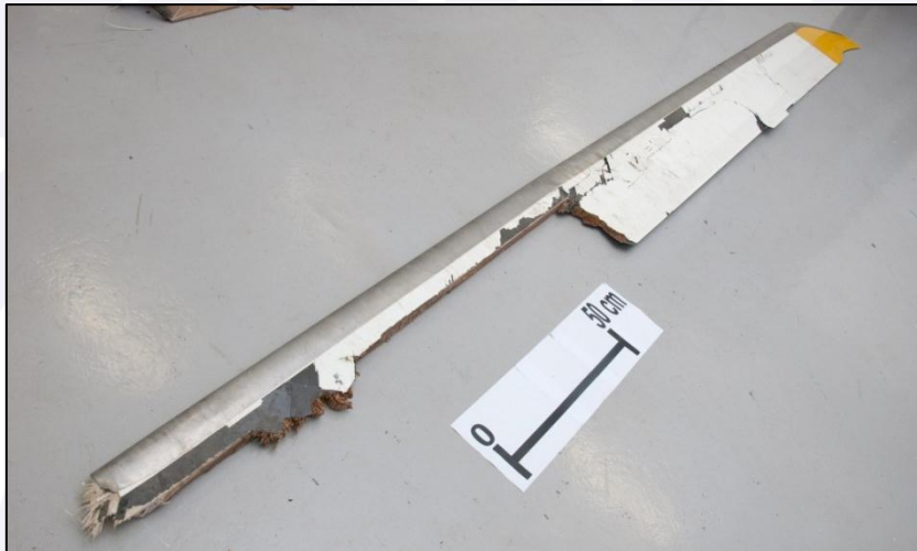
Figura 29 - Pá do rotor principal.
