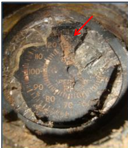
Figuras 10 e 11 – Velocímetro indicando 174 nós. A figura da direita apresenta o mesmo instrumento, após a remoção da proteção de vidro danificada pelo impacto.
