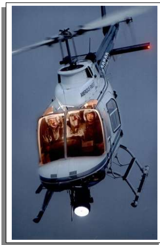
Figura 12 - Helicóptero Bell Jet Ranger da Polícia de San Diego Fazendo Uso do Farol de Busca Nightsun.
