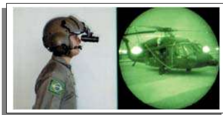
Figura 71 - Piloto do EB utilizando OVN e imagem de Helicóptero HM-3 Black Hawk visto com OVN.
