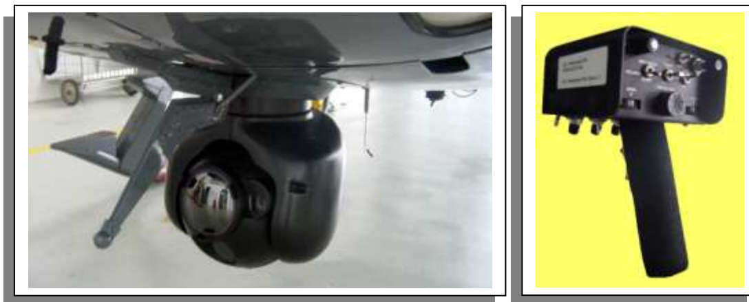
Figura 17 - Torre Ventral e Unidade de Controle do FLIR 2000.
