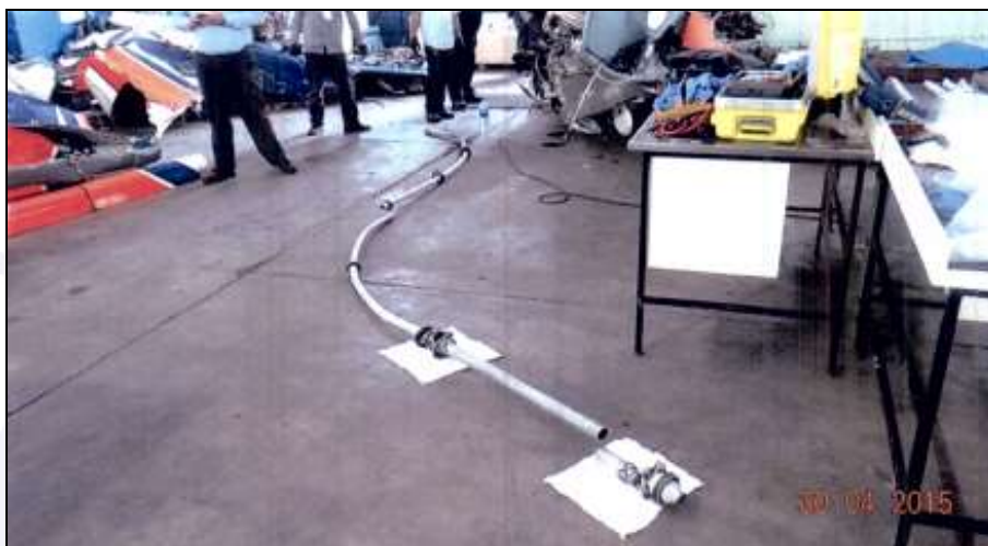
Figura 43 - Eixo de transmissão de potência para o rotor de cauda, com detalhe da flambagem.
