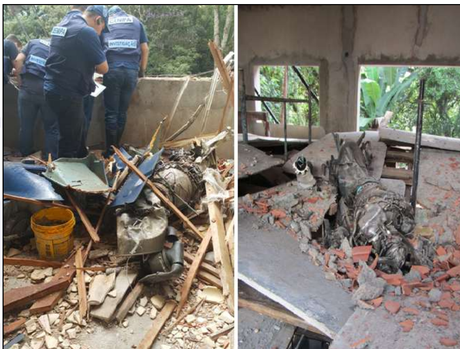
Figura 22 - Posição dos motores após impacto.
