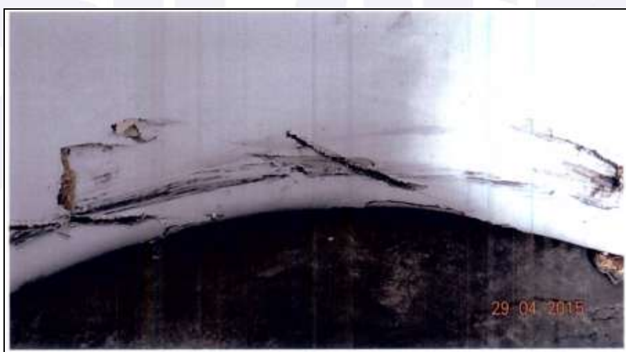
Figura 39 - Detalhe das marcas de penetração e corte provocadas pelas pás do rotor de cauda.
