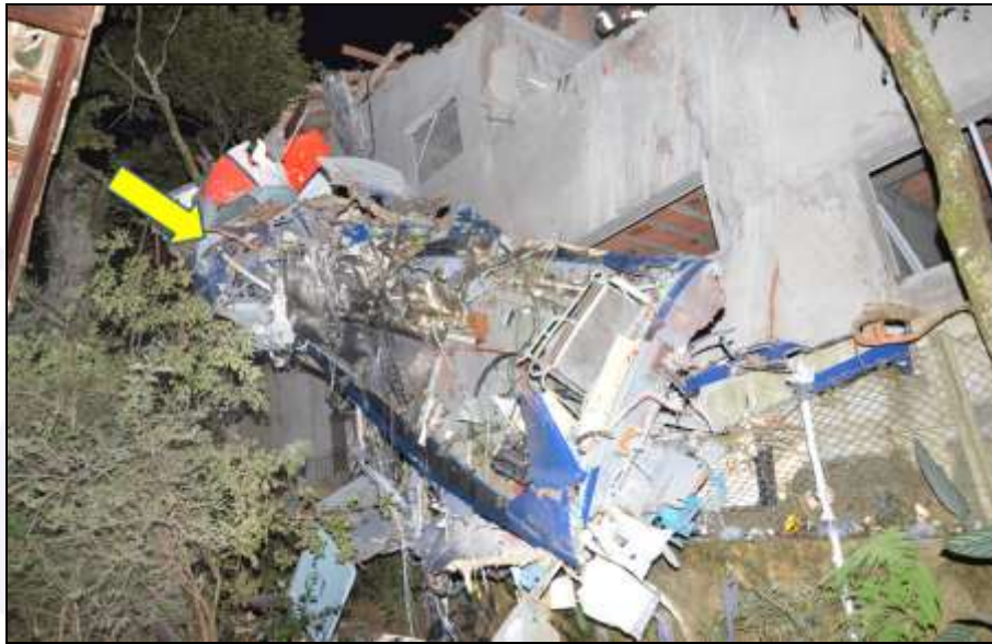
Figura 41 - Detalhe do eixo de transmissão de potência preso a fuselagem.
