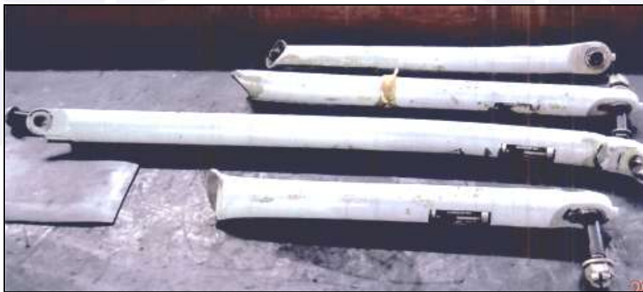
Figura 30 - Barras de fixação da CTP.
