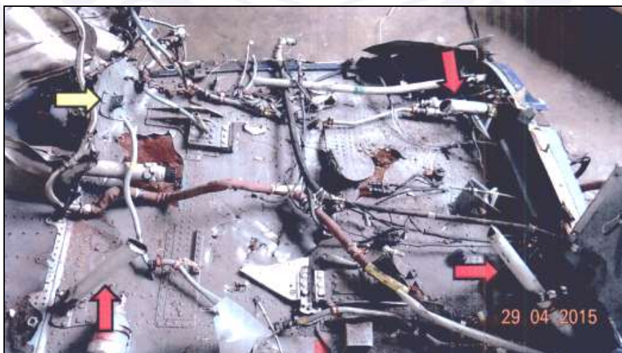
Figura 31 - Barras de fixação (setas vermelhas) e suporte de fixação (seta amarela).
