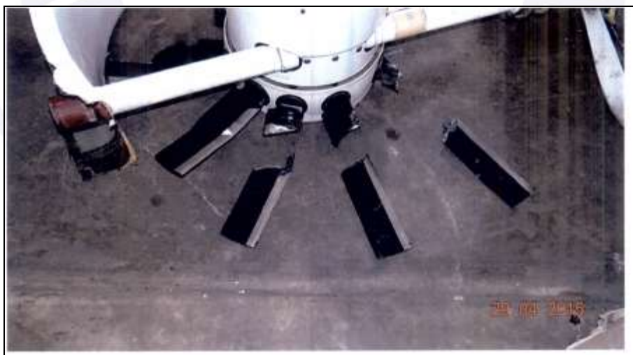
Figura 40 - Detalhe das pás fraturadas por flexão em sobrecarga.
