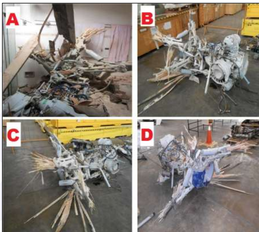
Figura 44 - Vista do conjunto do rotor principal, no local do acidente e no hangar (diversos ângulos).
