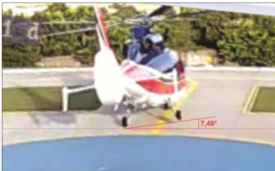
Figura 63 - Helicóptero inclinado à esquerda no início do taxiamento no solo. Ângulo de inclinação estimado.
