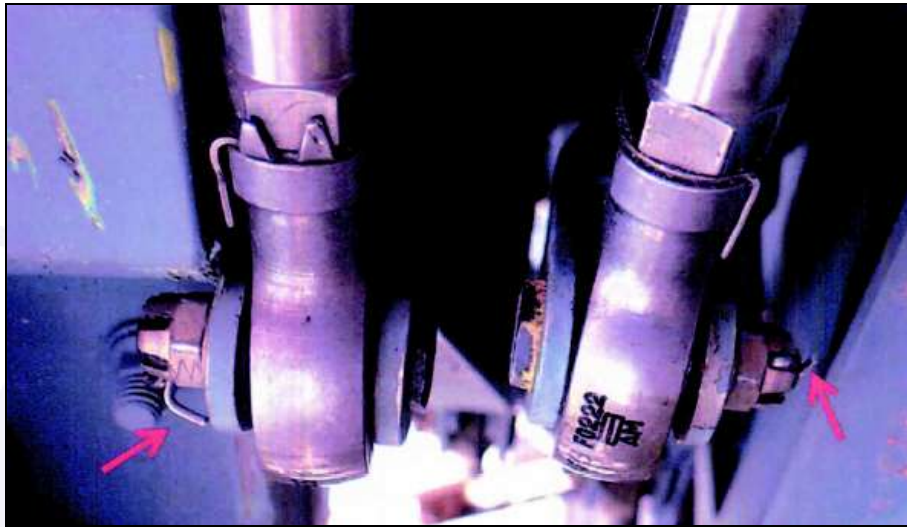
Figura 50 - LH Ball-Type flexible control roll, Ball-type flexible control pitch, LH roll bellcrank e Pitch bellcrank conforme encontrados nos destroços. As setas vermelhas mostram os contrapinos.
