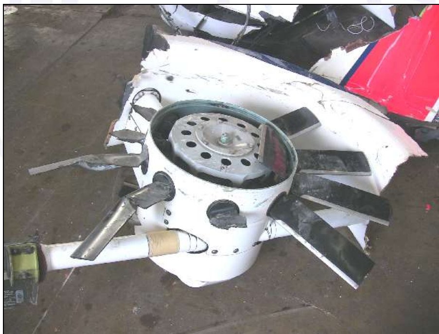
Figura 37 - Danos e marcas no Fenestron .
