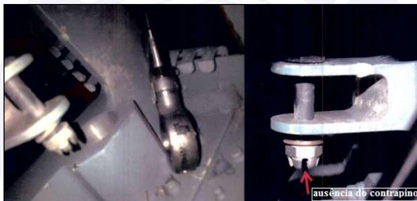
Figura 54 - RH roll ball-type flexible control e RH roll bellcrank encontrados desconectados e sem o contrapino.
