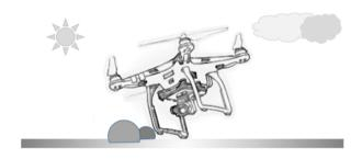
O voo lateral, próximo ao solo e com a presença de obstáculos, se constitui em condição ideal para o surgimento do rolamento dinâmico e o consequente tombamento do multirrotor. Identificado o perigo, o piloto remoto deve estar alerta e tomar medidas preventivas para assegurar que o multirrotor não entre nessa condição. Entretanto, ele deve, da mesma forma, saber o que fazer caso se observe, por alguma razão, este fenômeno.
