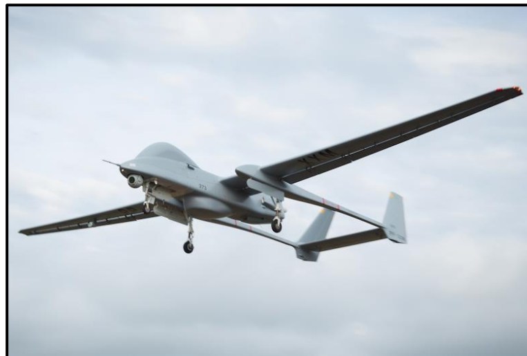
Figura 8 – VANT Heron 1 fabricado pela Israel Aerospace Industries (IAI)
