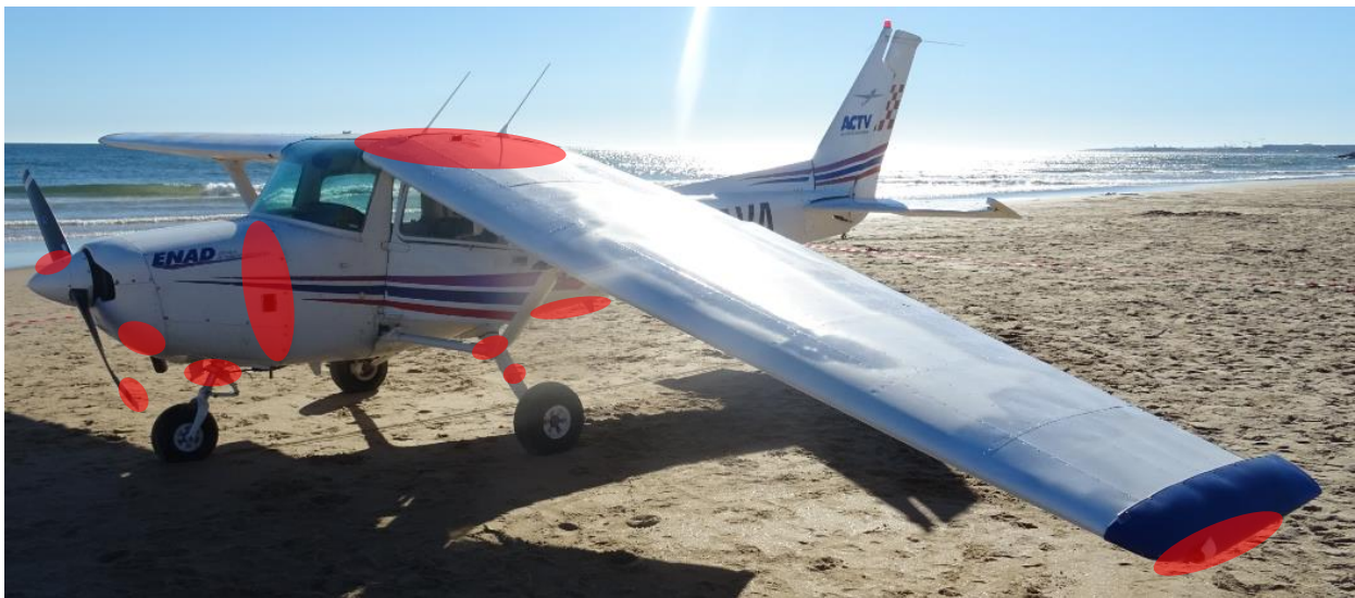
Figura 6 || Figure 6 Localização dos danos na aeronave || Aircraft damage location
