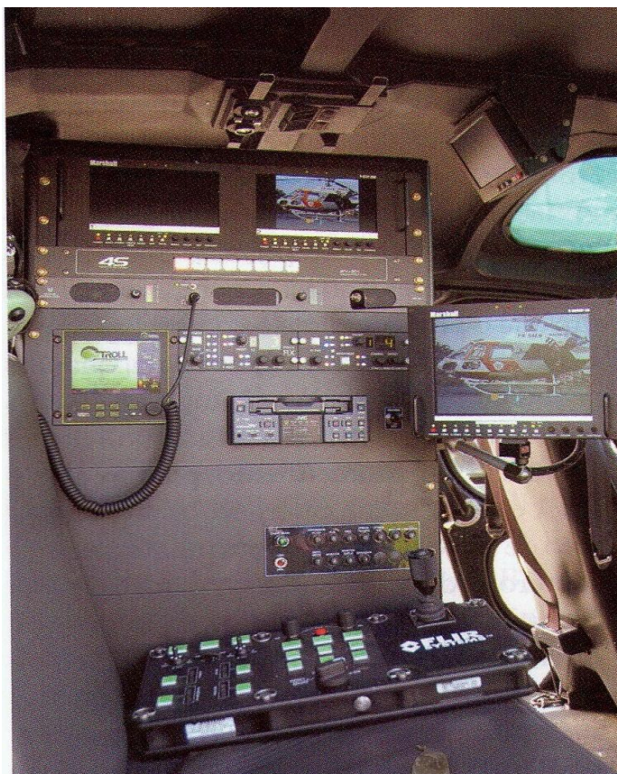
Foto 1: equipamento infravermelho utilizado pela Polícia Militar de São Paulo, instalado no banco traseiro do helicóptero
