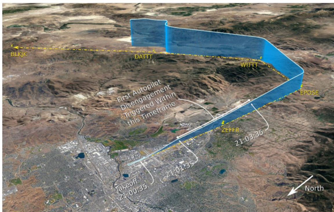
Figura 3: Sobreposição do mapa de dados do CAWS mostrando o evento de decolagem e a primeira desconexão do piloto automático.
